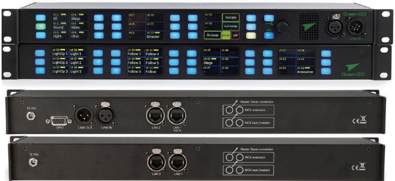
Green-GOマルチチャンネルデスクステーションは、個々のプッシュボタンからチャンネルに直接アクセスできます。各チャンネルには、「トーク」と「リスニング、コール、キュー」用のマルチカラープッシュボタンがあります。各チャンネルのテキスト表示は、名前と音量レベルを示します。ソフトメニューボタンは主な操作マスター機能をコントロールし、デスクには一体型スピーカーとマイクXLRコネクタが装備されています。ショーリレー、分散型オーディオおよびページングアナウンスには、ラインイン/アウト接続とルーティングが用意されています。
